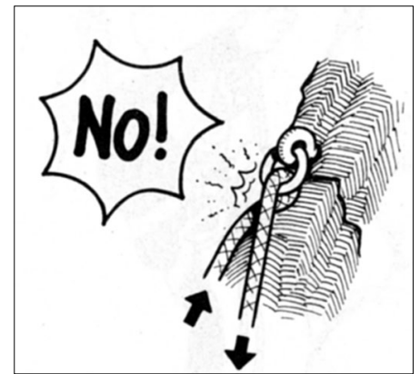
Abb. 2: Abklemmgefahr beim Abziehen von einem Ringhaken: Wird, wie dargestellt, das äußere Seil gezogen, kann das Seil klemmen bleiben. Es muss daher das Seil gezogen werden, das am Fels anliegt!
